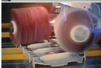
→ La souplesse des brosses évite l'attaque des bossages (35 mm maxi) et l'altération des surfaces (plaquage aluminium plus particulièrement)
