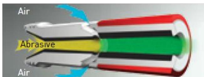
Le type double venturi peut être considéré comme deux buses à la file avec un écart et des trous entre les deux pour faciliter l'entrée de l'air atmosphérique dans la partie descendante de la buse. Le segment de sortie est également plus large qu'une buse ordinaire. Cette modification augmente la taille de l'expulsion et minimise la vitesse de l'abrasif.
