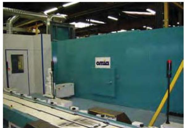
Tunnel polymérisation avec convoyeur à plateaux
