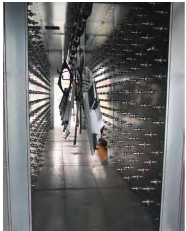
Séchage après tunnel de dégraissage
