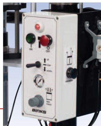
*Boîtier de contrôle fonctionnel pour utilisation simplifiée.*
