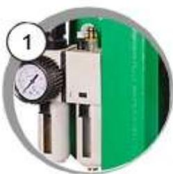
L'aéroréfrigérant ACP est équipé d'un régulateur de pression, pour commander le débit d'air du ventilateur, d'un filtre et d'un lubrificateur pour assurer la longévité du variateur pneumatique
