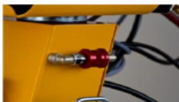
Bouton inverseur pour actionner l'aspiration extérieur de la canne à travers le bras support de celle-ci. Cette aspiration est obtenue par dépression d'un venturi.
