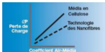
Les cartouches filtrantes à nanofibres permettent une exploitation à haut débit (augmentation de 30 à 50%) tout en maintenant une perte de charge constante. Le fait d'adopter des coefficients air-média plus élevés ou d'utiliser des systèmes moins imposants diminue les coûts d'exploitation.
